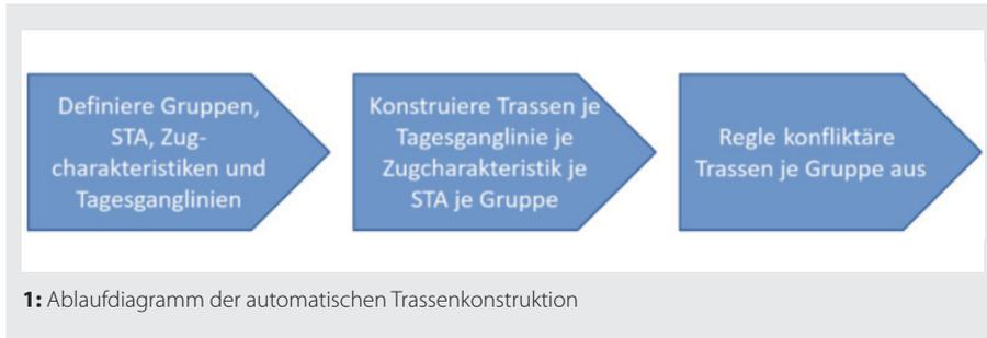
1: Ablaufdiagramm der automatischen Trassenkonstruktion
